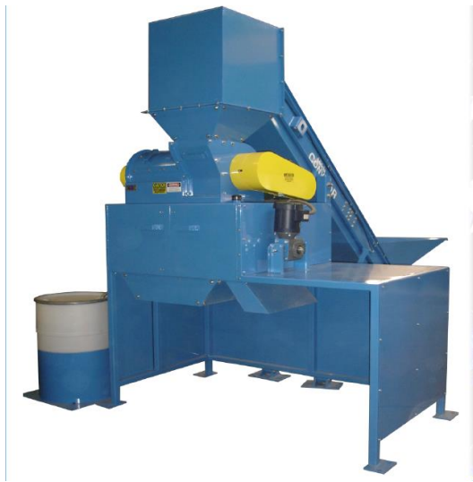
Pulvérisateur à verre (0.5t/h) fournissant un broyat sableux (source Andela Products)
